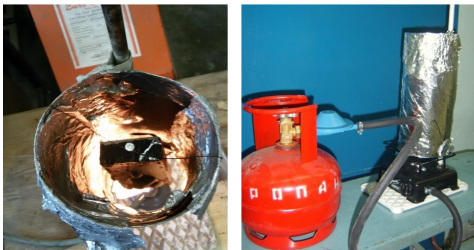
Рис. 1. Экспериментальная лабораторная установка для определения огнезащитной эффективности антипиренов
