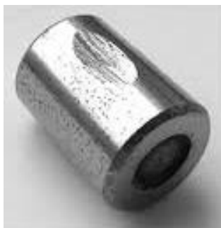
Рис. 2. Износ ролика при трении о вал (лунки сверху)
