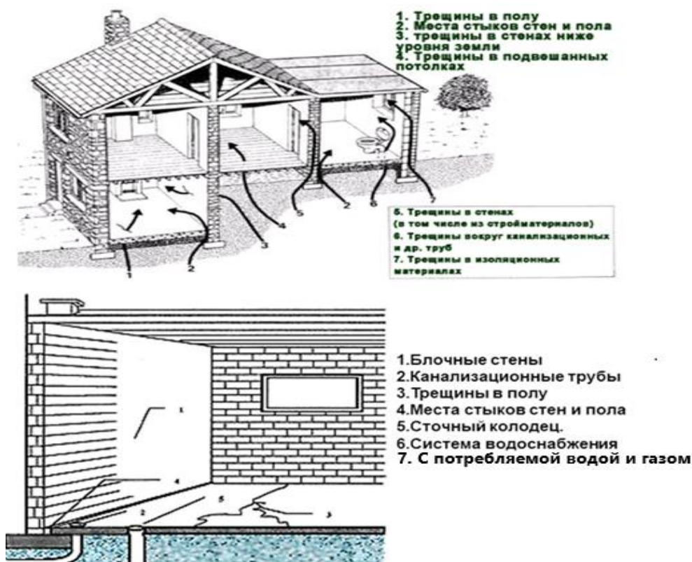
Рис. 1. Источники радона в помещении
